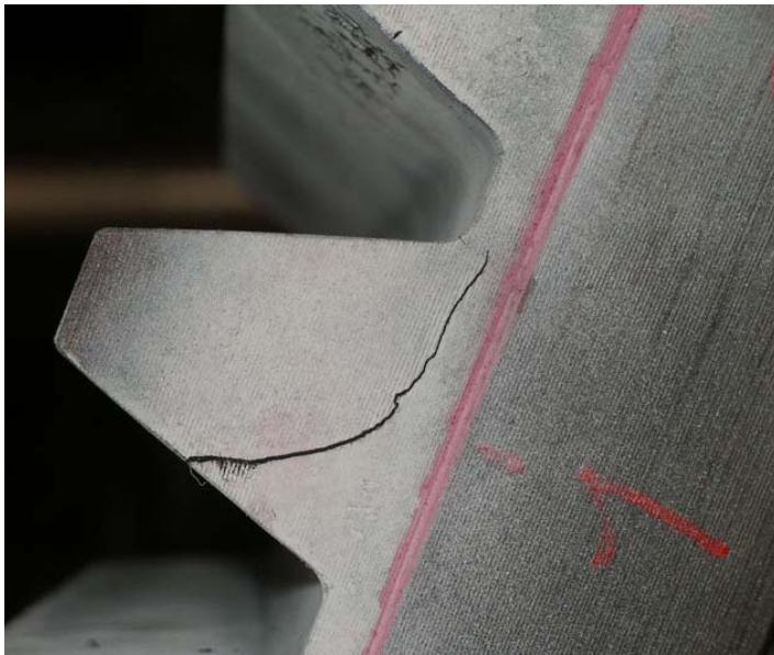
Fissure sur un engrenage*
